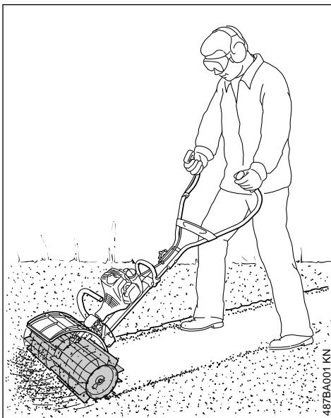
MultiNástroj "válcový čistič KW-MM" slouží k čištění ploch a cest, smetávání vlhkého materiálu jako např. mokrého spadaného listí nebo špíně dohromady, odklízení sněhu nebo odstranění vody.
